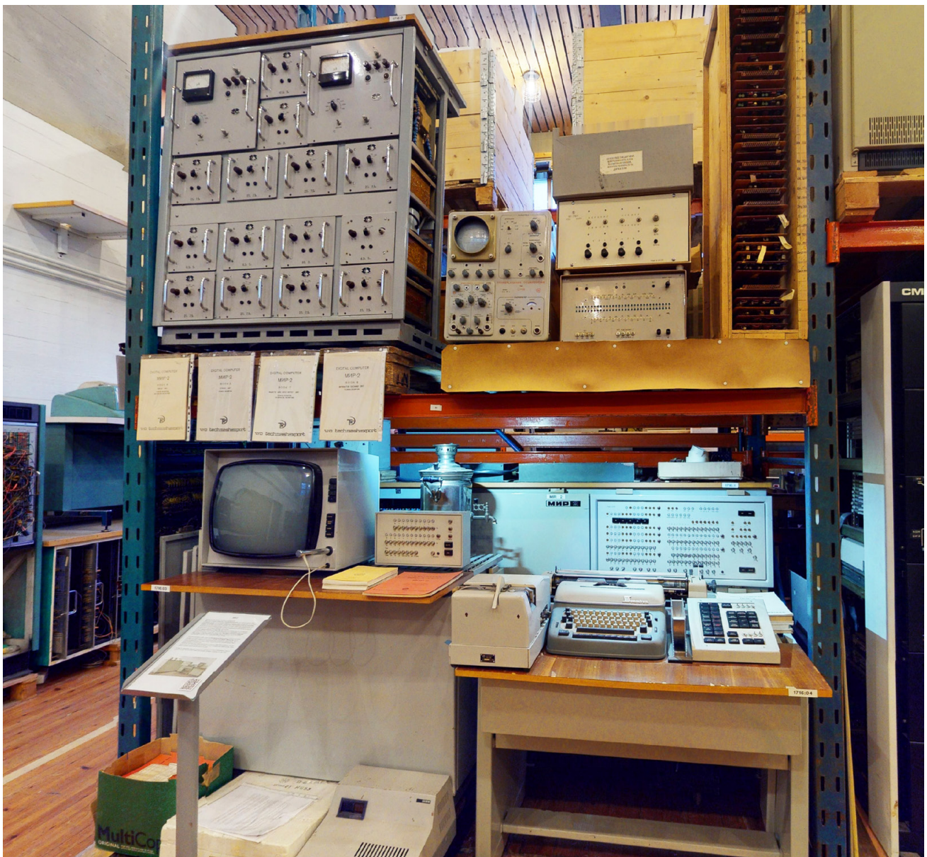
Neuvostoliittolainen MIR-2 (julkaistu 1969) lattiatasossa. Koneen erikoisuus oli interaktiivinen käyttöliittymä, jota ohjattiin kuvaputkinäyttöön kytketyllä valokynällä. Kynä näkyy putkinäytön oikeassa alanurkassa. Suuri neliömäinen laitteisto ylähyllyn vasemmassa laidassa on tietokoneen virtalähde. MIR-2 oli käytössä Teknillisessä korkeakoulussa, Helsingissä, vuodesta 1974 alkaen, ja se lahjoitettiin Suomen tietokone-museolle vuonna 2003. (Kuva: Suomen tietokone-museo)
